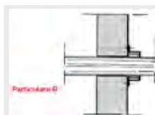
Nel caso che il sistema venga applicato alla compartimentazione orizzontale REI che separa un'area a rischio di fuoco. Usare un solo collare esternamente al solaio (Ø max 200 mm)
