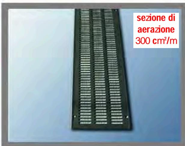
**Aerprofilo Sottotegola** è un elemento di smaltimento per l'aria calda in sommità per tetti ventilati qualora non sia possibile l'utilizzo del Colmovent 600 (ad esempio falda addossata ad una muratura)
