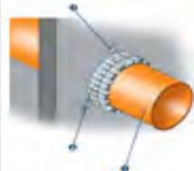
Collare intumescente modulare per la protezione dal fuoco REI 120 di passaggi di tubazioni combustibili in tecnopolimero, PVC, PE - collaudato per tubazioni fino a 200 mm
